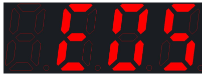
故障代号显示(外部电源故障)
