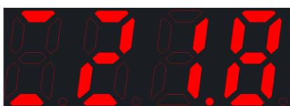
2#水泵电流值 (单位: A)
