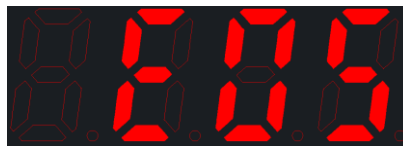
故障代号显示(外部电源故障)
