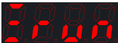
3#水泵运行(不使用互感器)
